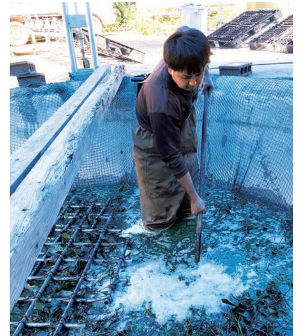
直径2～3m、深さ約1.2mの大きな藍壺に水を溜めて、琉球藍の葉を漬け込む。攪拌作業は体力勝負だ。
