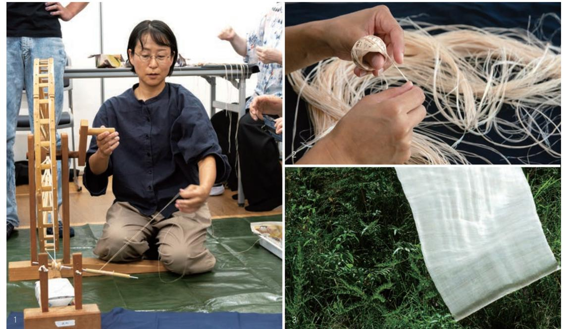
1.毛羽立ちを防いで丈夫にするため撚りかける工程。後続の工程に影響がでるため、熟練した技術が必要。大城さんが「ヤーマ」と呼んでいる糸撚り機は沖縄では多くの呼び方があり、喜如嘉では「チンギバタ」と呼ばれている。2.芋績みの前のチング巻きの工程。長いままでは扱いづらいため、毬状に成形する。乾燥させた繊維を2〜3本ずつ左手の親指に巻きつけ綺麗にまとめていく。3.太陽の光を浴びると、より輝きが増す芭蕉布。1反の布を織るのに200本の糸芭蕉が必要である。
